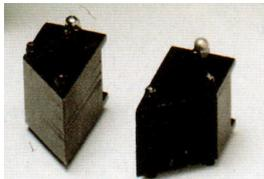
45° Vorsatzpole zur Prüfung an Kehlnähten
