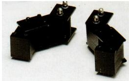
Bewegliche Vorsatzpole zur Prüfung an unparallelen Flächen wie Winkelstücke und Rohrbögen
