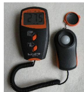
UV - Intensitätsmessgerät J221
