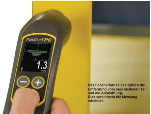
Das Fadenkreuz zeigt zugleich die Entfernung vom beschichteten Teil und die Ausrichtung. Dies vereinfacht die Messung erheblich.
