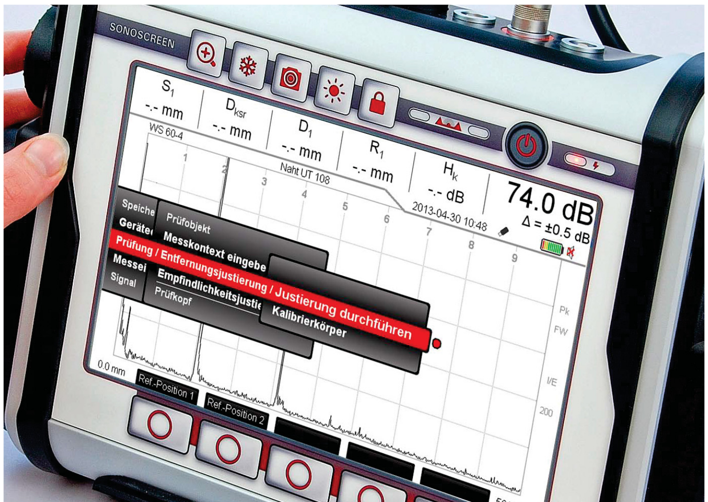
Orientierung garantiert – durch Anzeige des Menübaumes und rote Kennzeichnung des Menüpfades
